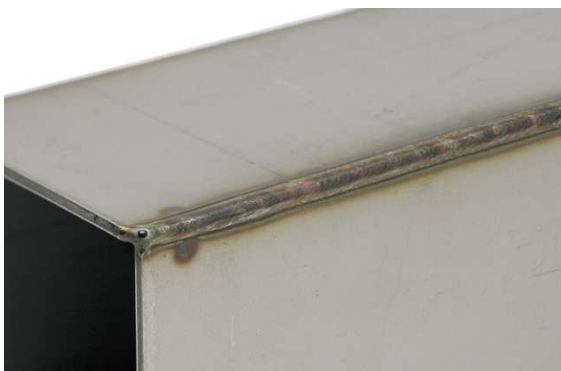
Soldadura Inoxidable en Rincón
